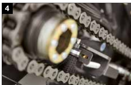
Stabile und breite Schmierbürsten für optimale Kettenschmierung
