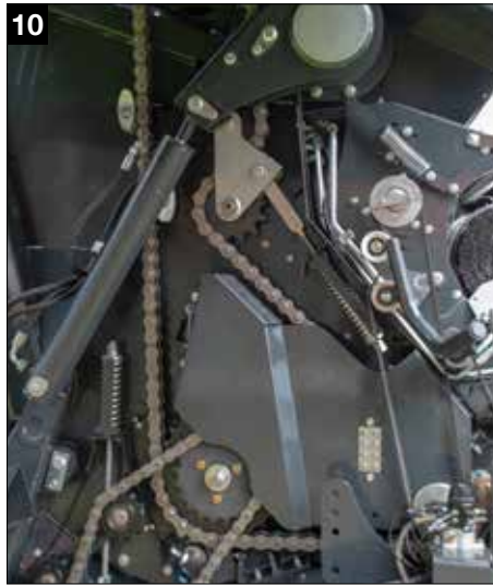
10 Robuster Antrieb mit verschleißfesten, überdimensionierten Ketten
