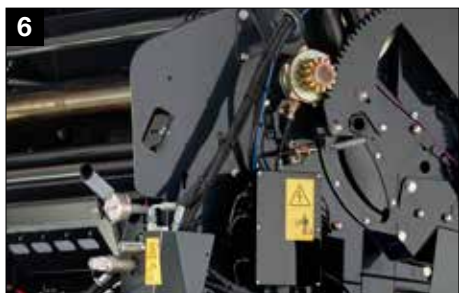
Proportionalventil für die Dichteregelung aus der Fahrerkabine
