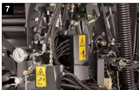
7 Proportionalventil für die Dichteregelung aus der Fahrerkabine
